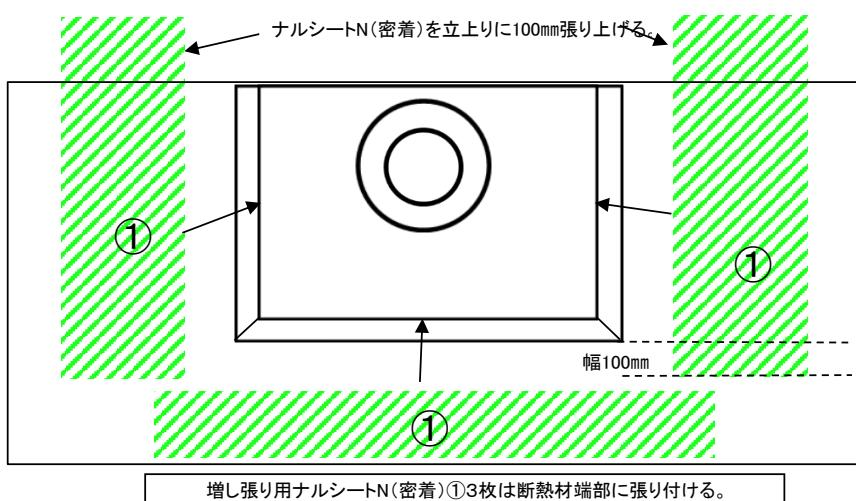
※ 側溝を設ける場合は、その断熱材端部は上記と同様に200mm幅のナルシートN(密着)の増し張り補強を行う。
